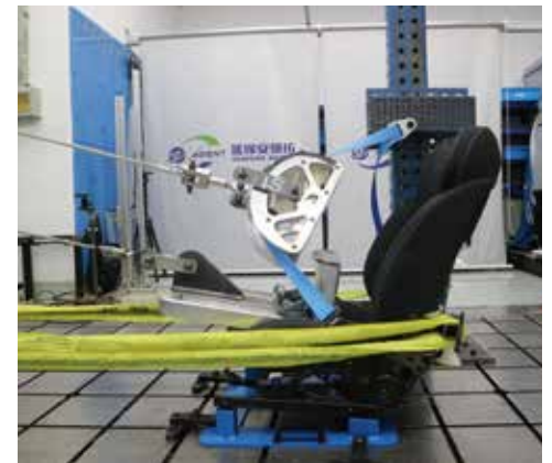
图：安全带固定点强度试验
